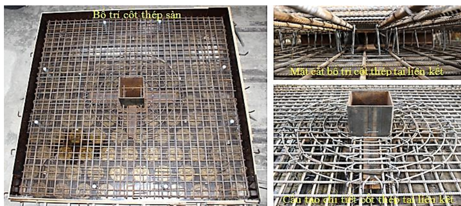
Hình 1.10. Liên kết cột CFST với sàn phẳng BTCT sử dụng shearhead [4].
