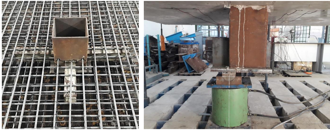
Hình 2.1. Mẫu nghiên cứu thực nghiệm liên kết chịu tải lệch tâm [22]
