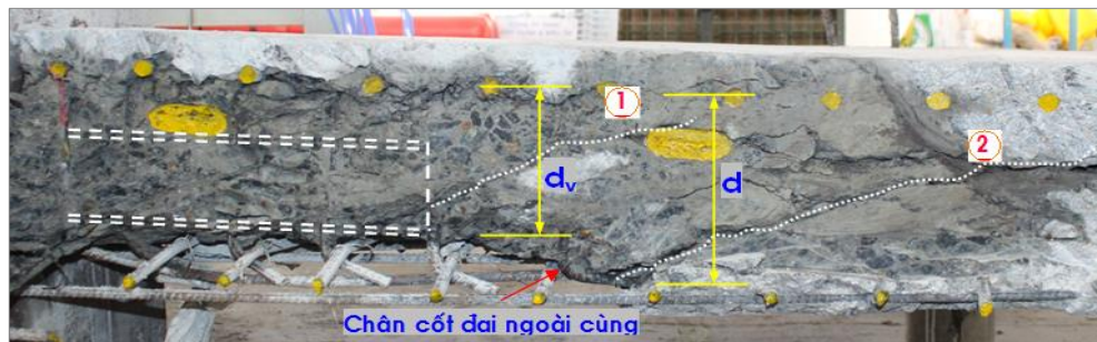
Hình 2.12. Chiều cao làm việc chịu cắt d_v xác định từ kết quả thí nghiệm
