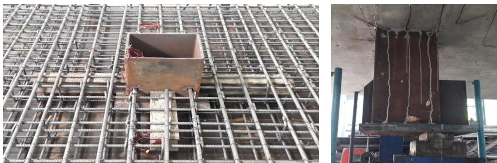
Hình 2.6. Mẫu nghiên cứu thực nghiệm liên kết chịu tải lệch tâm [23]
